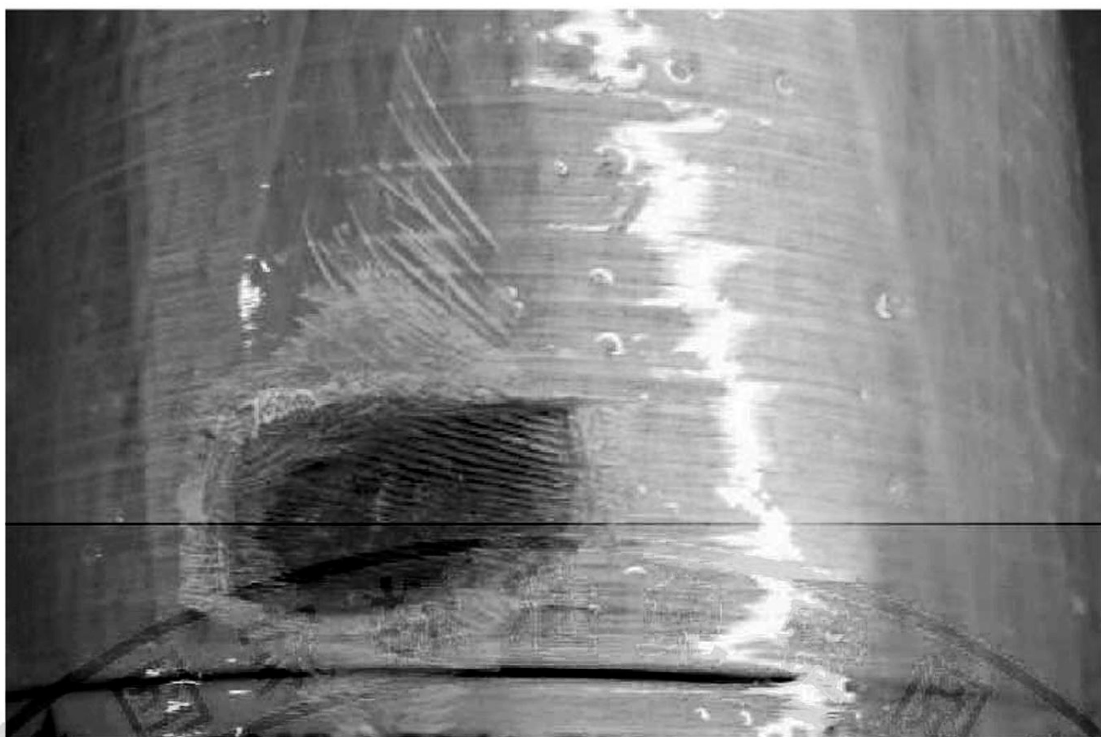
图 F.4 三级磨损(报废)
